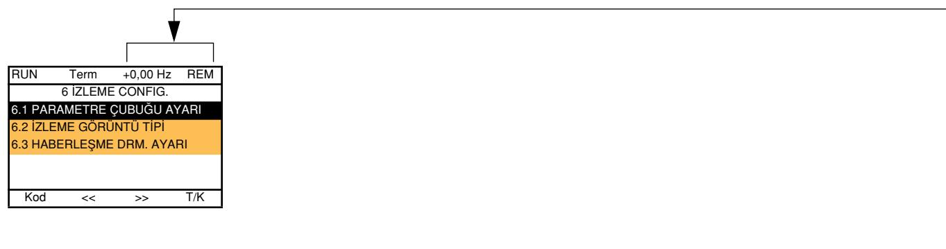
[6.1 PARAMETRE ÇUBUĞU AYARI]: Üst satırda görüntülenen 1 - 2 parametrenin seçilmesi (ilk 2 değiştirilemez).
