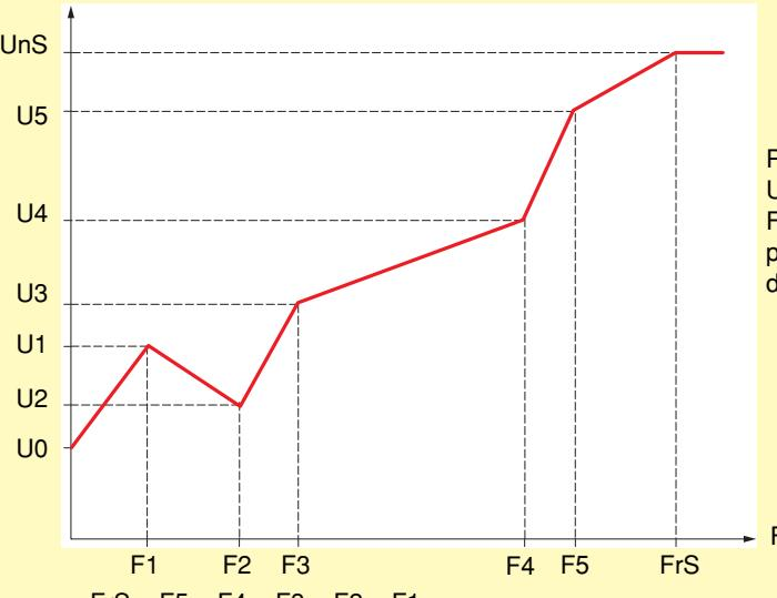
Profil, UnS, FrS ve U0 - U5 arası ve F0 - F5 arası parametrelerinin değerleri ile                                                                                                                                                                                                                                     |               |                         |
